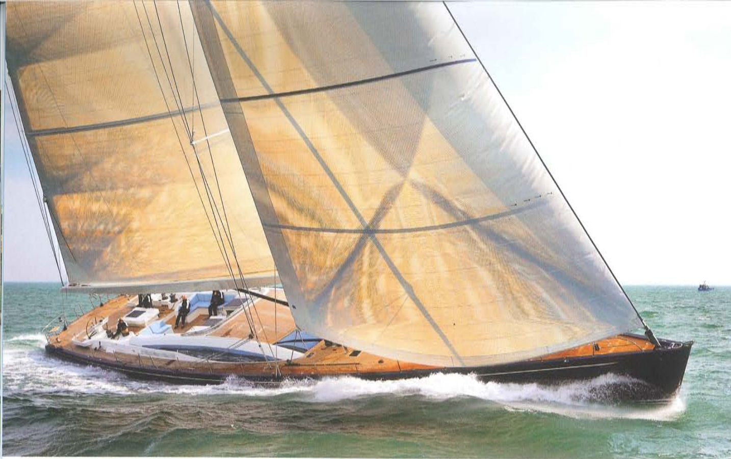
“哈密尔顿II”:35米长, 配备2005年产升降龙骨, 由CNB采用碳材料制成。帆面积:616 平方米。
