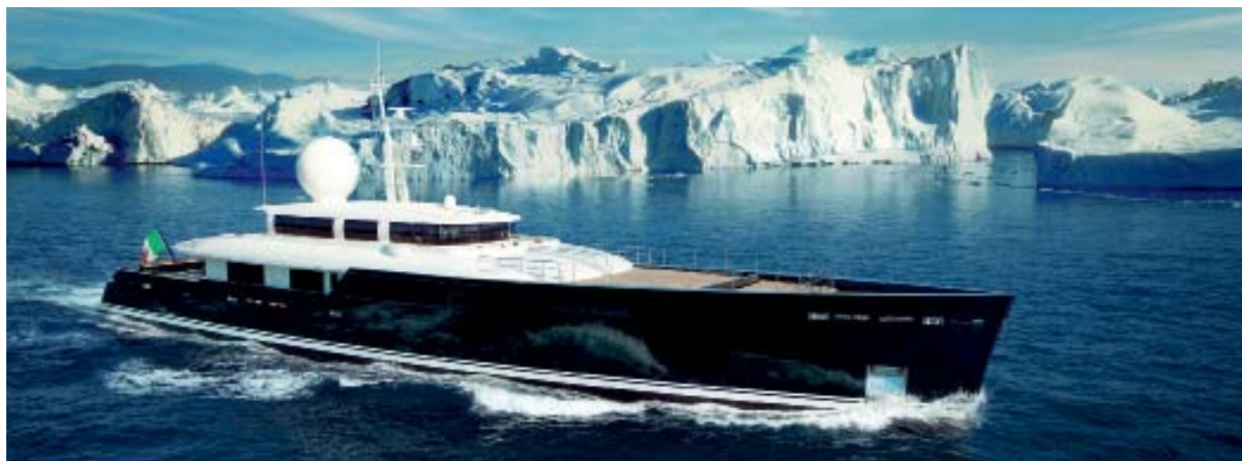
Galileo G: обводы корпуса выдают убедительное и серьезное судно. Длина 55 м, ширина 10,39 м, осадка 3,2 м
