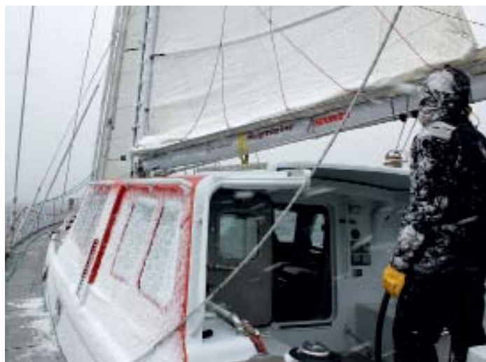
Pelagic Australis имеет алюминиевые корпус, палубу и мачту
